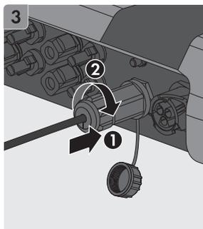
DC Connection | DC-Anschluss | Свързване на постоянен ток | DC připojení | DC-tilslutning | Σύνδεση DC | Conexión de CC | Alalisvoolühendus | DC-liitäntä | Raccordement DC | DC-priključak | DC-csatlakoztatás | Collegamento CC | Nuolatinės srovės jungtis | Lidzstrāvas pieslēgums | DC-aansluiting | Przyłącze DC | Ligação CC | Conexiune DC | DC prípojka | Priključek DC | Likströmsanslutning
